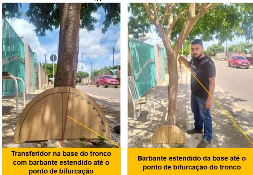
Figura 2. Detalhes da medição do grau de inclinação dos troncos das árvores de Cojoba arborea com transferidor adaptado.
