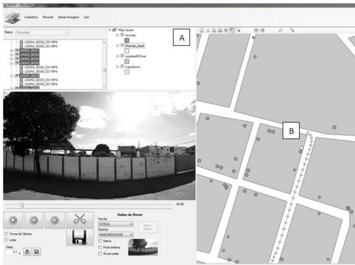
Figura 3. Exemplo da interface do software para o georreferenciamento das árvores ilustrando (A) a escolha de uma via a ser visualizada e os comandos para a edição do vídeo e (B) mostrando o sentido do deslocamento e a posição um momento antes do posicionamento de uma árvore (círculo branco)
