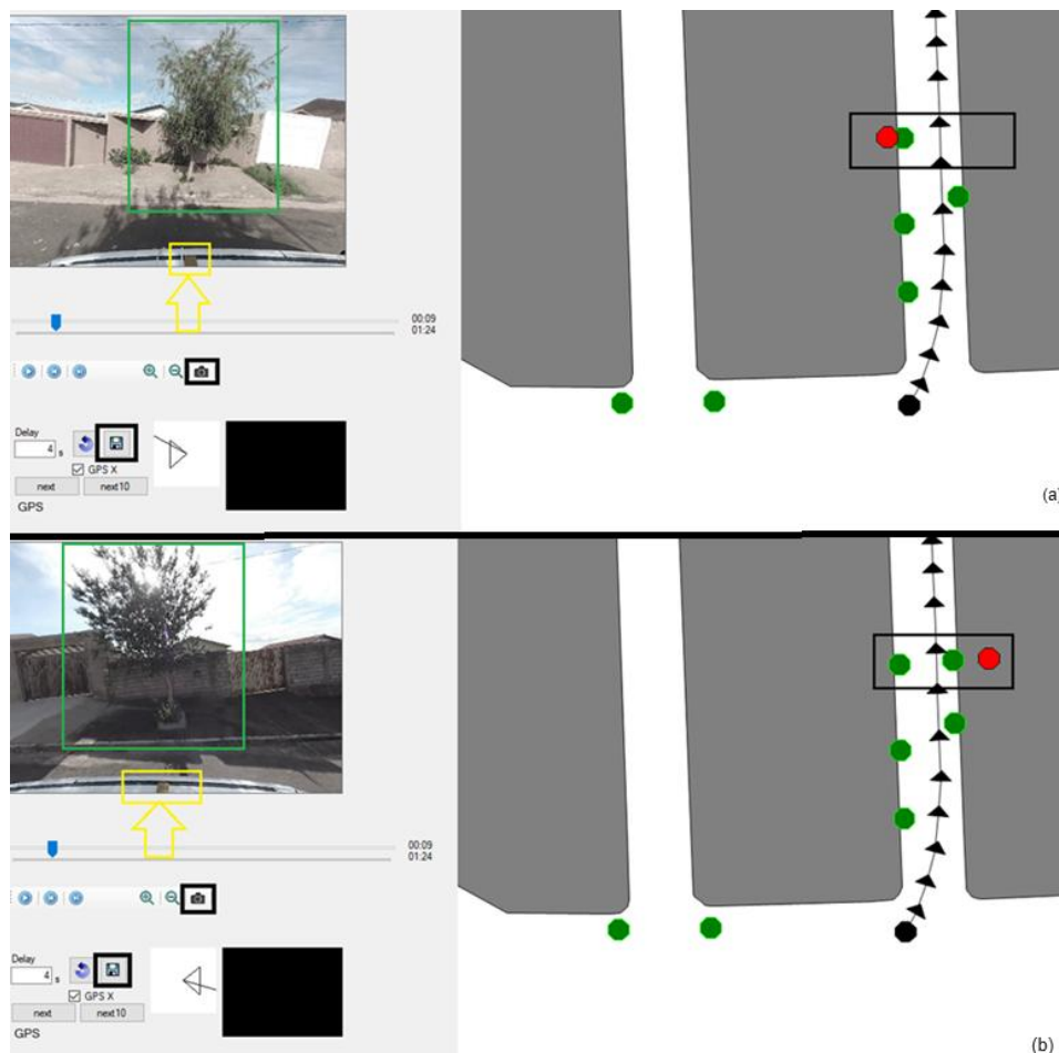
Figura 3. Identificação e georreferenciamento de uma árvore com um vídeo. Figure 3. Identification and georeferencing of a tree using a video.
