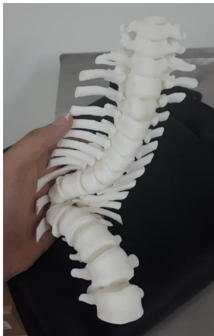
FIGURA 3 – PROTÓTIPO DA COLUNA DO PACIENTE IMPRESSO EM SLS
