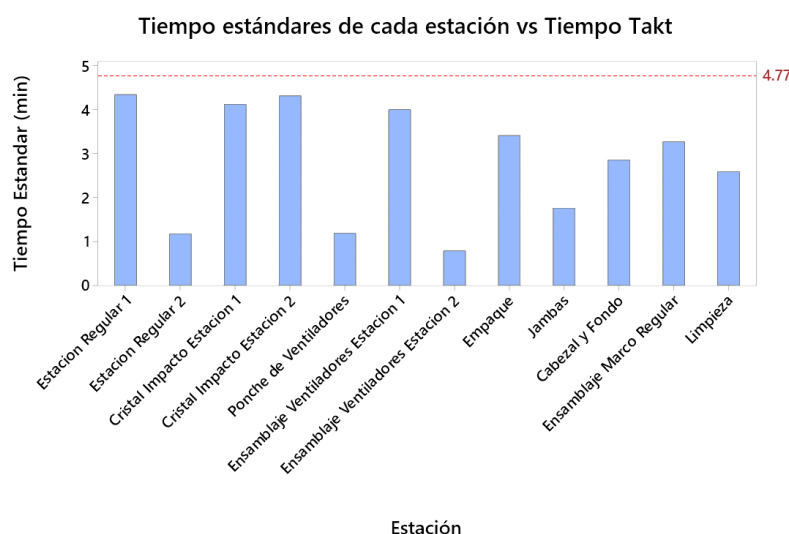
FIGURA 8 - LÍNEA BALANCEADA PARA CUMPLIR CON EL TIEMPO TAKT.
