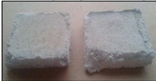
Figura 3 – Amostras do painel após ensaio de ataque por fungos
