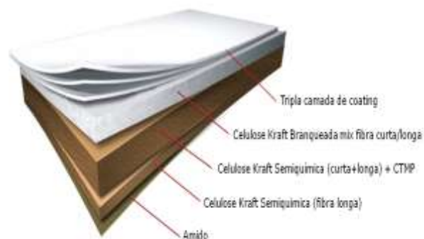
FIGURA 2: ESTRUTURA DO PAPEL CARTÃO EM CAMADAS
