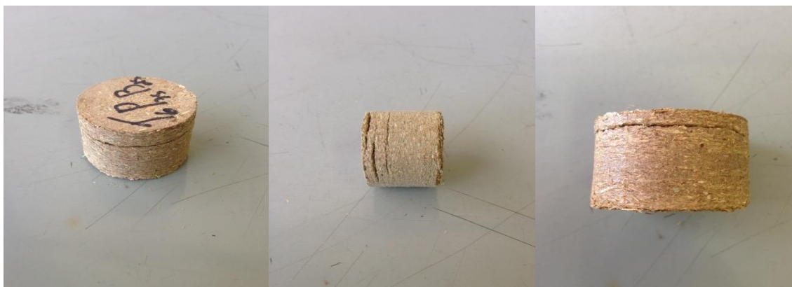
Figura 2: Ruptura transversal dos briquetes.
