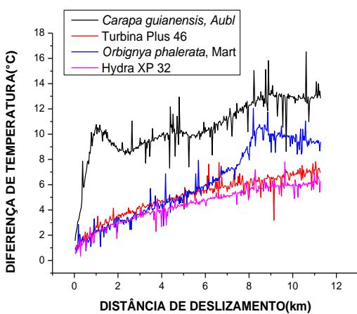
O monitoramento das temperaturas apresentou o óleo LUBRAX HYDRA XP 32 com o menor aquecimento na região de contato ao longo dos 11 km de deslizamento, o que pode ser explicado pela aditivação antidesgaste, enquanto o óleo de andiroba apresentou maior aquecimento na região de contato. A aditivação antidesgaste, segundo (QU et al., 2014) reduz o coeficiente de atrito de 45% a 60% em relação a um óleo base sem aditivo.
