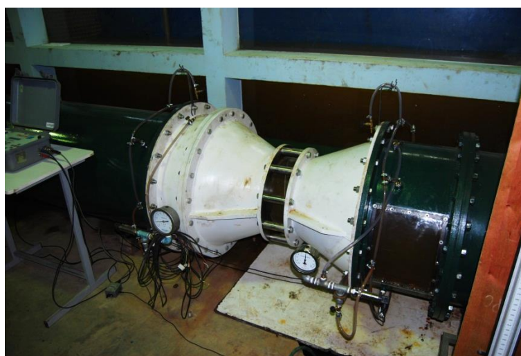
Figura 4. Modelo de turbina montado na bancada de ensaios.
