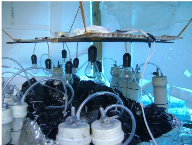
Figura 5 – Placa de PVC com lâmpadas incandescentes para aquecimento.
