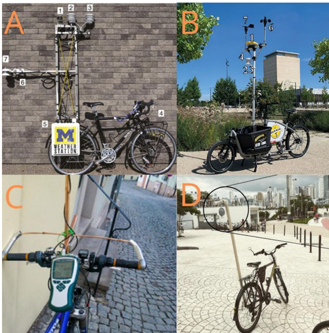
Figure 7 - Equipamentos acoplados às bicicletas para medições móveis encontrados em alguns dos artigos selecionados. A) (RAJKOVICH et al, 2016), B) (EMERY et al, 2021), C) (MICHAL et al, 2018), D) (WRITZL et al, 2022). Fonte: Autores (2024).
