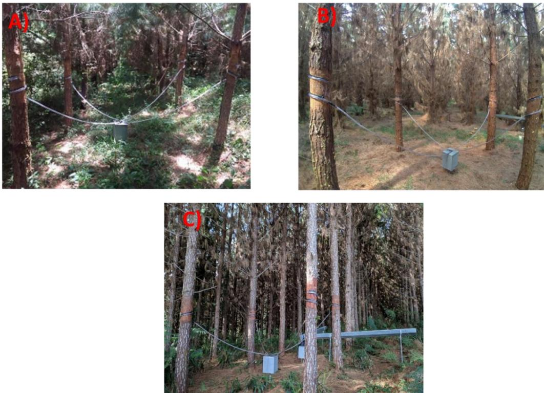
Figura 3- Imagens dos três experimentos e respectivos sistemas coletores do escoamento de tronco, calhas coletoras da precipitação interna e abrigos das básculas, sendo A) E1 (plantação com 5 anos), B) E2 (plantação com 7 anos) e C) E3 (plantação com 10 anos). Fonte: os autores, (2024).
