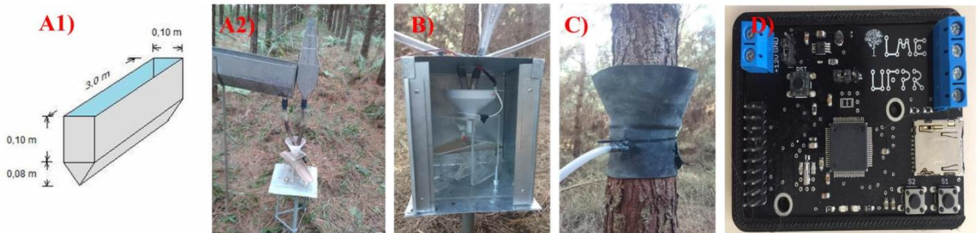
Figura 4- Aparato utilizado no monitoramento automático dos componentes da interceptação (precipitação interna e escoamento de tronco). A1) dimensões da calha para coleta da precipitação interna, A2) calhas e balança, B) balança e abrigo, C) anel coletor de escoamento de tronco, D) datalogger. Fonte: os autores, (2024).
