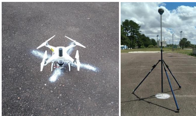
Figura 3– PHANTOM 4 ADVANCED da DJI, com o KIT PPK2 da Guandalini acoplado e exemplo de rastreamento em campo com ponto sinalizado. (elaborado pelos autores)
