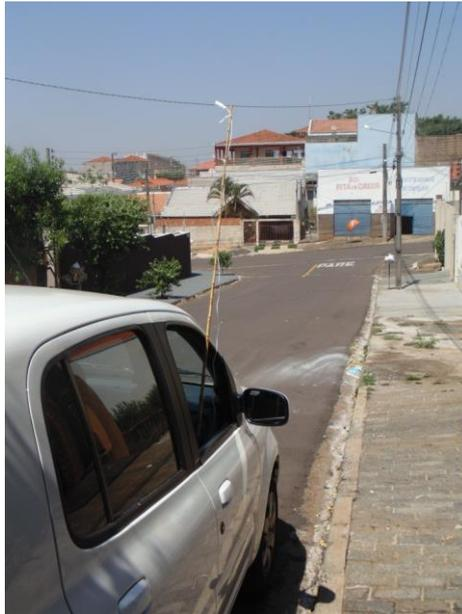
Foto 1. Veículo equipado com haste para o transecto móvel. O sensor foi fixado em sua extremidade. Fonte: Arquivo pessoal.
