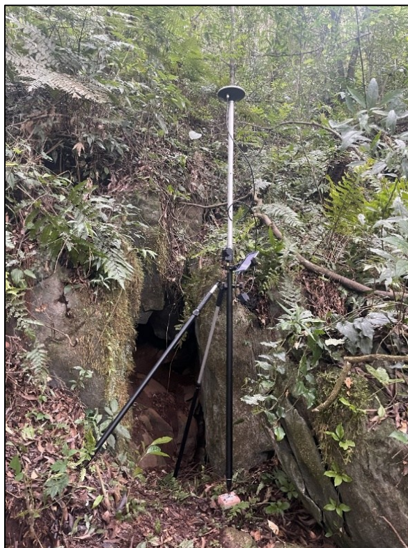
Figura 2 — Sistema receptor instalado sobre marco topográfico para a obtenção de dados de rastreamento GNSS (Gruta Taici I) e definição das coordenadas (Latitude e Longitude) e da altitude.
