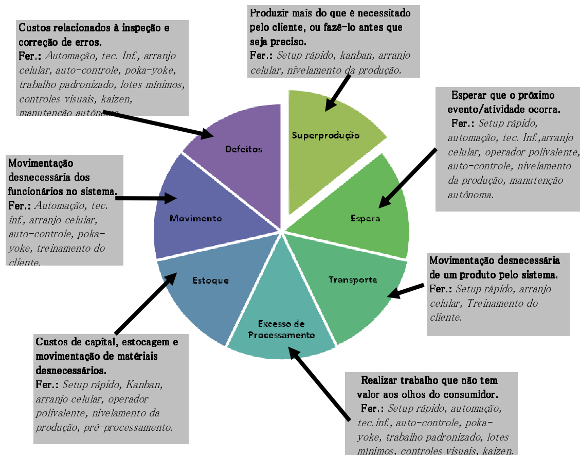
Figura 01 – Relação entre as perdas em um sistema produtivo e as ferramentas Lean utilizadas para atacá-las. Fonte: Adaptado de GIANNINI (2007).
