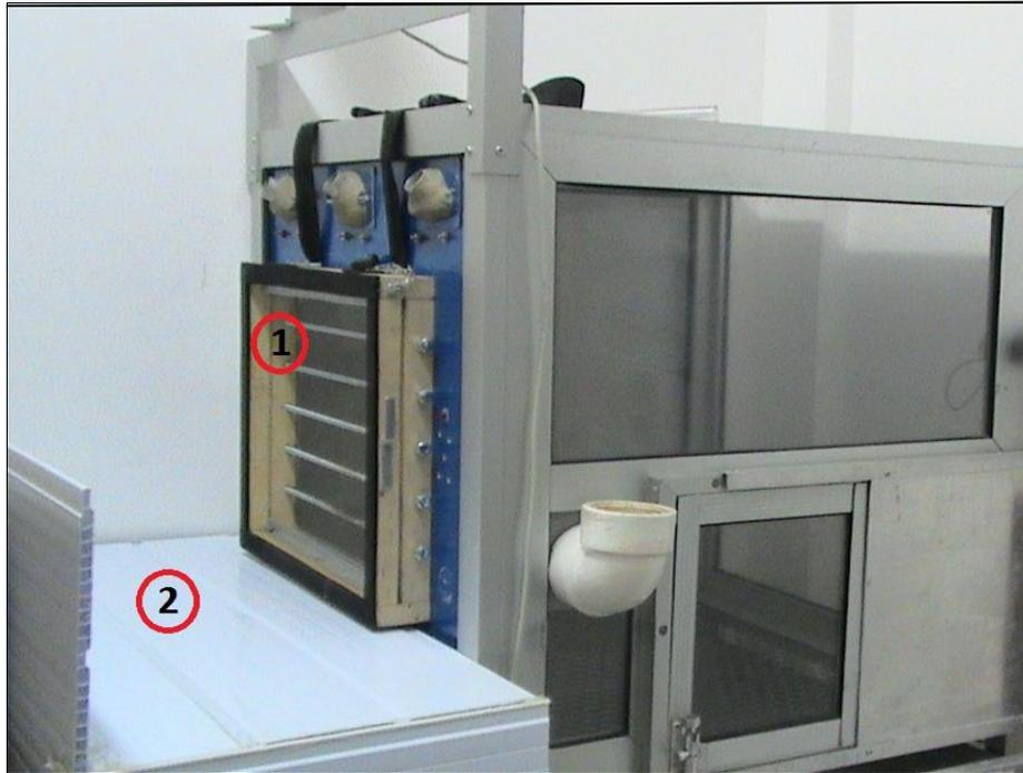
Figura 5. Câmara experimental. O número 1 corresponde à abertura na câmara, por onde o sujeito teve acesso às ferramentas; e o número 2 indica o mini-tablado em cima do qual foram dispostas as ferramentas para o desenvolvimento das tarefas (LOUIS).
