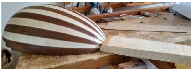
Fig.17: junção inicial do bloco e braço
