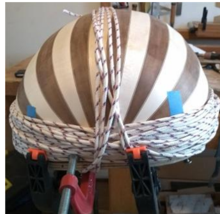
Fig. 7: colagem da faixa
