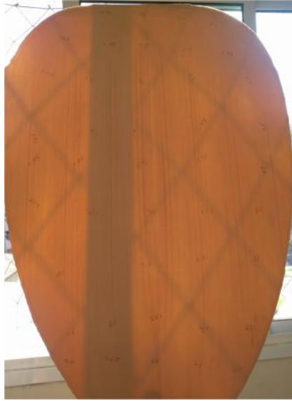
Fig. 9: tampo aplainado próxima da espessura final
