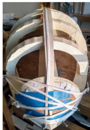
Figura 4: início da colagem das faixas
