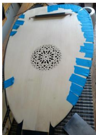
Fig. 26: colagem dos frisos
