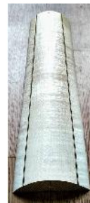
Fig. 20: braço laminado aplainado
