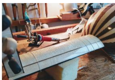
Fig. 29: Processo de entrastejamento
