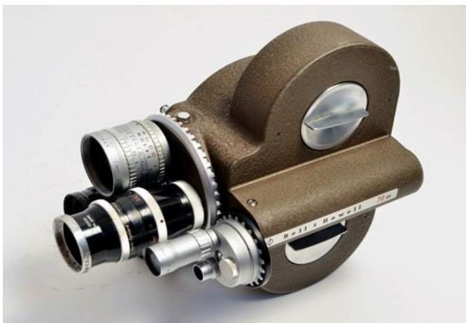
Imagem 3 Câmera Bell & Howell 70DR "Filmo" 16mm. Modelo da câmera cinematográfica utilizada para reportagens e documentários.
