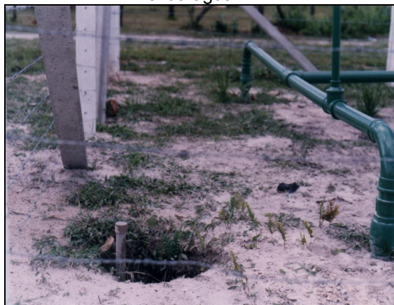
Figura 11 - Piezômetro para observação do nível da água.
