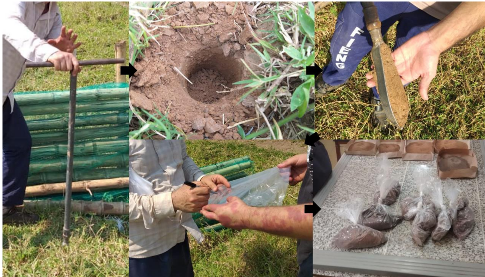
Figura 3: Coleta de amostras de solo com o uso do trado do tipo Holandês.
