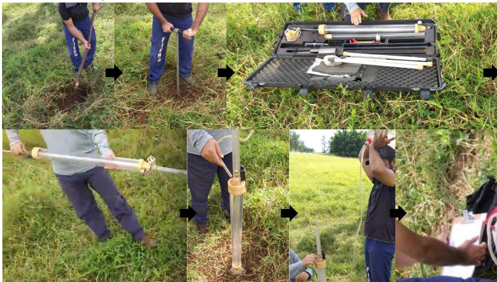
Figura 4: Utilização do Permeâmetro de Guelph em campo.
