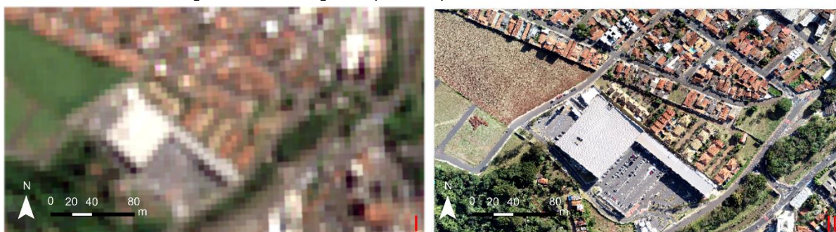
Figura 6: Ortomosaico apresentado pelo Sentinel 2 e pelas imagens o Drone Phantom 4 Pro. Legenda: I – representação da ortofoto do Sentinel, do ano de 2019; II – representação da ortofoto gerada pelo processo de aerofotogrametria das imagens capturadas pelo Drone Phantom 4 Pro, de 2019.
