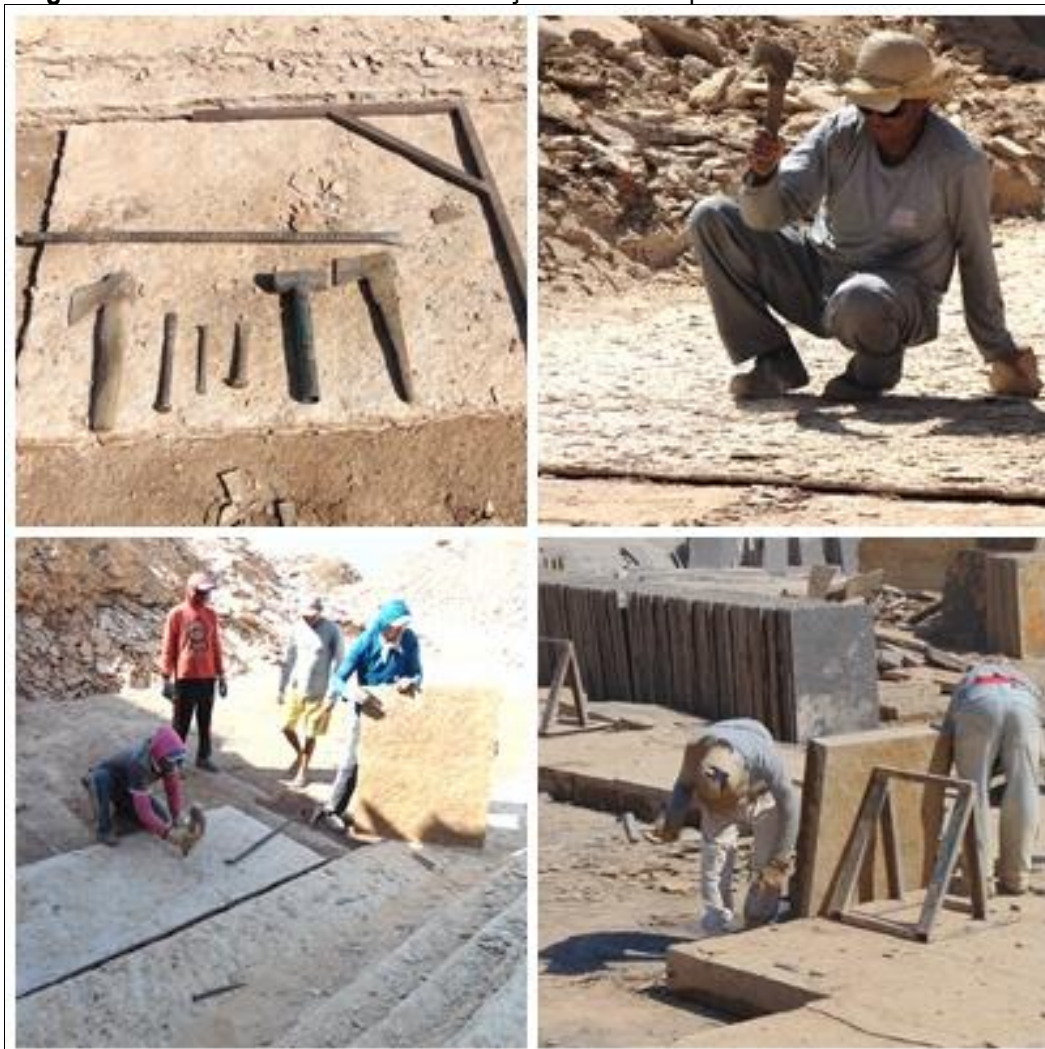
Figura 6: Ferramentas utilizadas na extração de rochas quartzíticas na área em estudo
