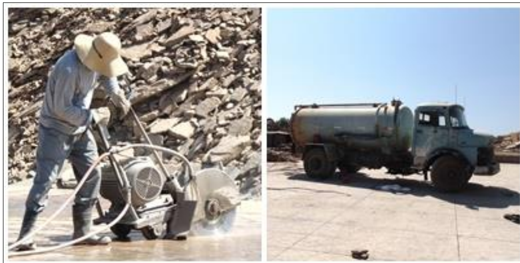
Figura 7: Etapa de corte da rocha quartzítica por meio do uso de maquinário no município de Castelo do Piauí
