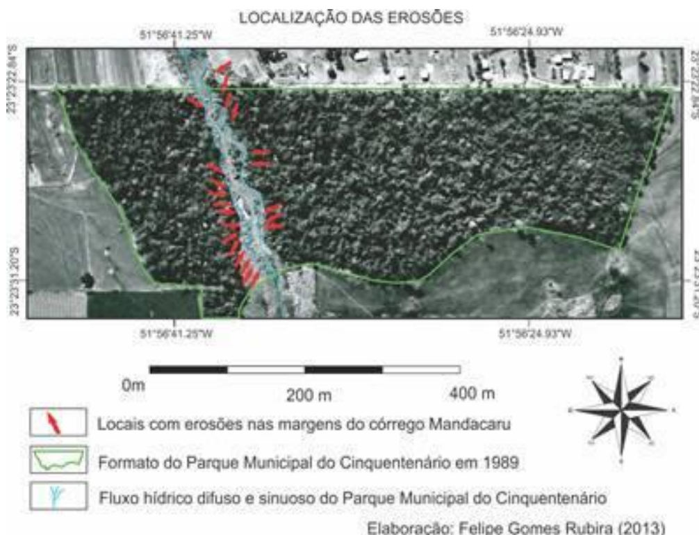
Figura 6: Localização das erosões nas margens do córrego Mandacaru Fonte: O autor (2013). Adaptado de Prefeitura Municipal de Maringá (2013)
