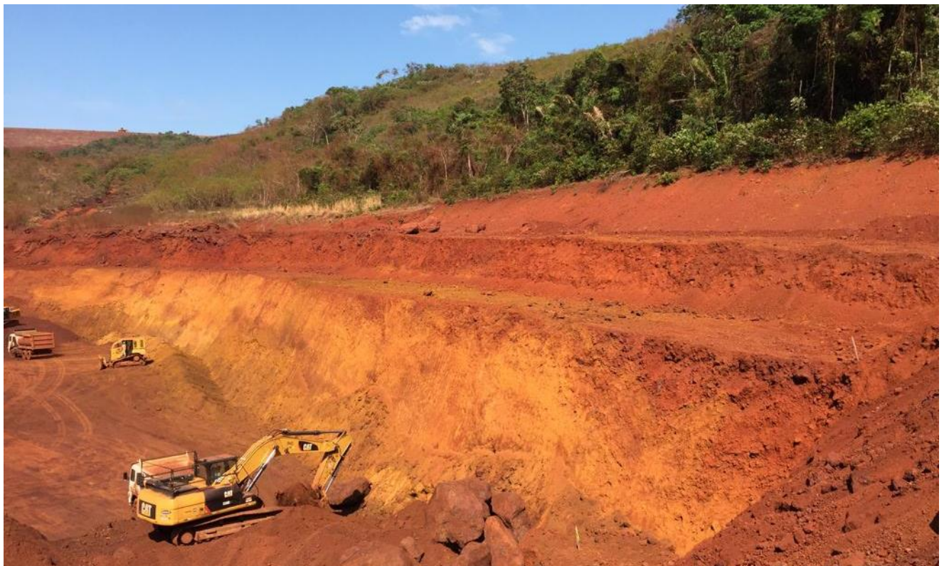
Figura 6. Foto apresentando o saprólito de rocha vulcânica situada no topo da camada de formação ferrífera.
