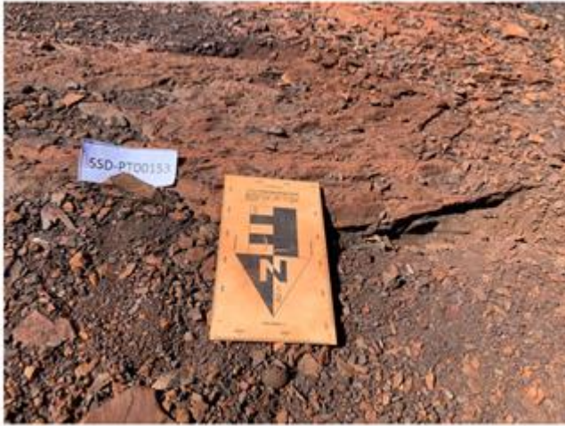
Figura 12. Foto de hematititos compactos, muito fraturado, apresentando estruturação horizontalizada.
