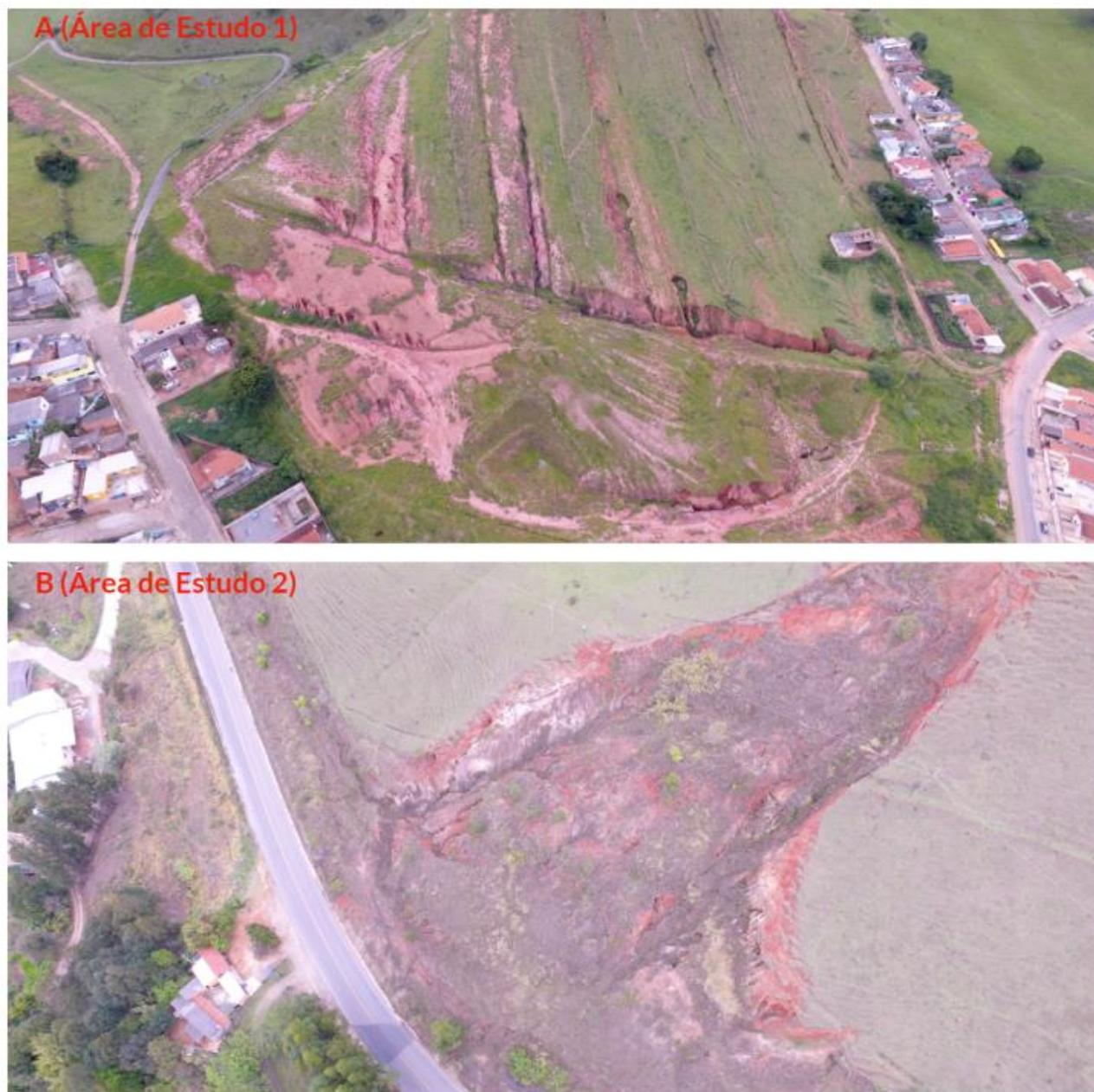
Figura 4.a) Voçoroca na área de estudo 01 e b) Voçoroca na área de estudo 02.
