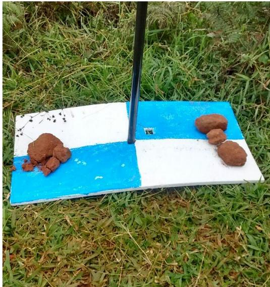
Figura 5. Elementos artificiais utilizados como pontos de controle.
