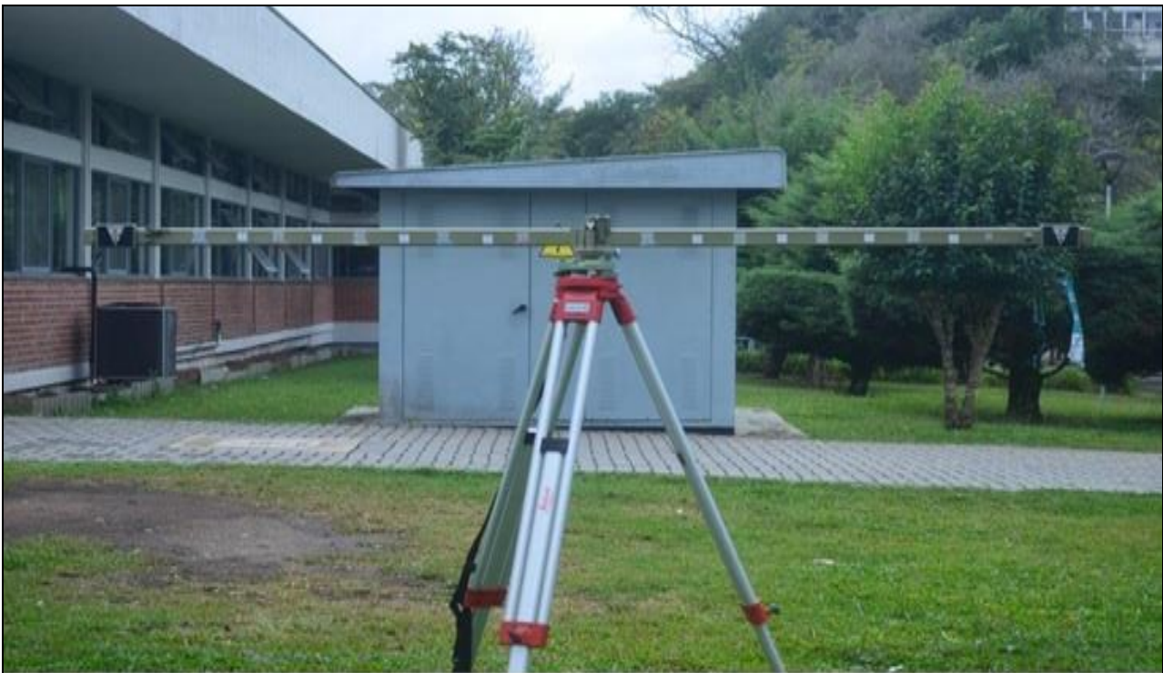
Figura 4 - Mira horizontal de Invar de 2 metros (A Autora, 2018).
