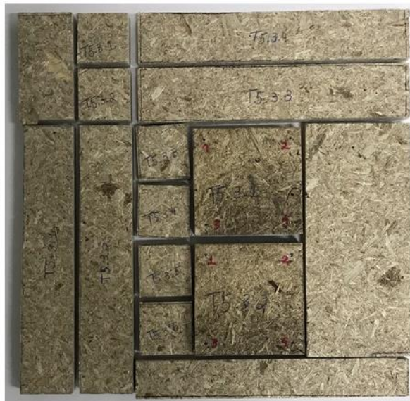
Figura 1. Layout utilizado no processo de esquadramento dos painéis aglomerados.
