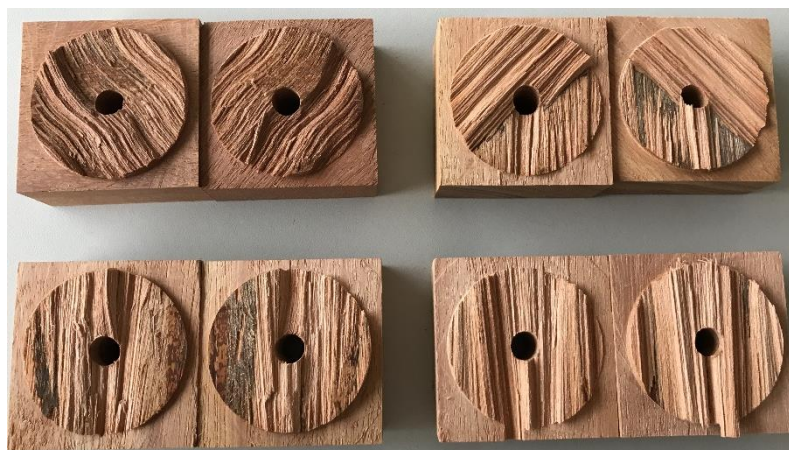
Figura 6. Corpos de prova rompidos à torção, colados à 45° acima, e colados paralelos às fibras abaixo.
