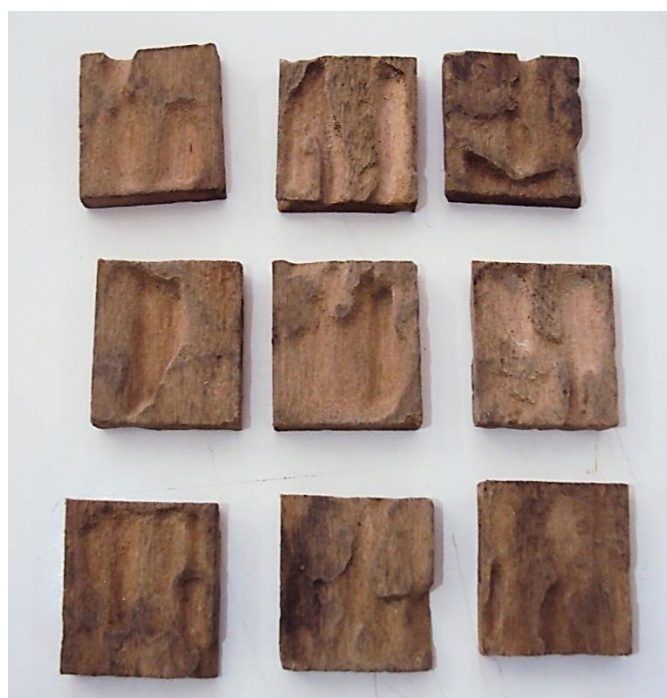
Figura 1. Corpos de prova da madeira de Liquidambar sp. atacados após ensaio de alimentação forçada com cupins Nasutitermes corniger
