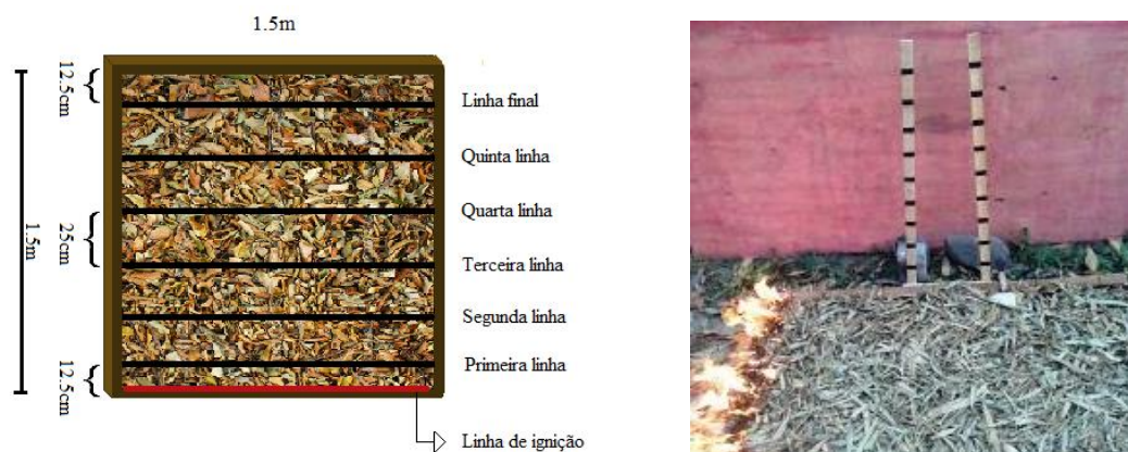
Figura 2. Croqui da mesa de combustão (esquerda) e detalhe das régua adaptadas para auxiliar na determinação do comprimento das chamas (direita).
