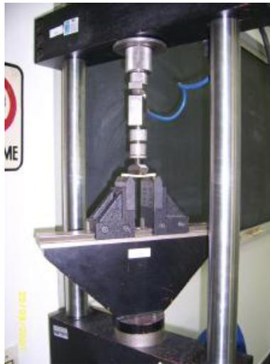
Figura 3. Dispositivo utilizado para o ensaio de flexão estática.
