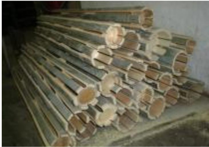
Figura 2. Colmos cortados para obtenção das ripas.
