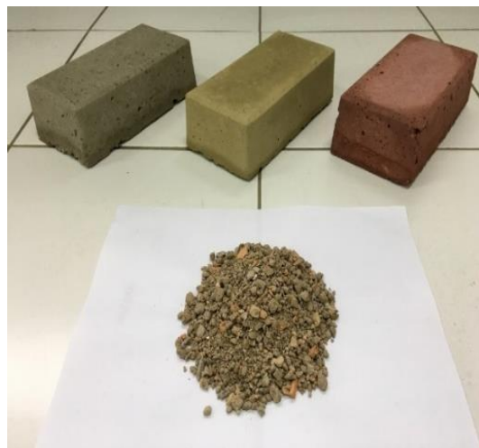
b) Agregado e pavers produzidos com RCD Fonte: Autoria própria (2019).
