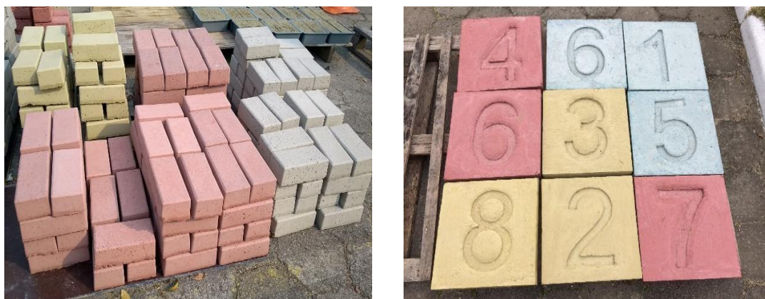
Figura 11 – Pavers e placas coloridos produzidos com RCD
