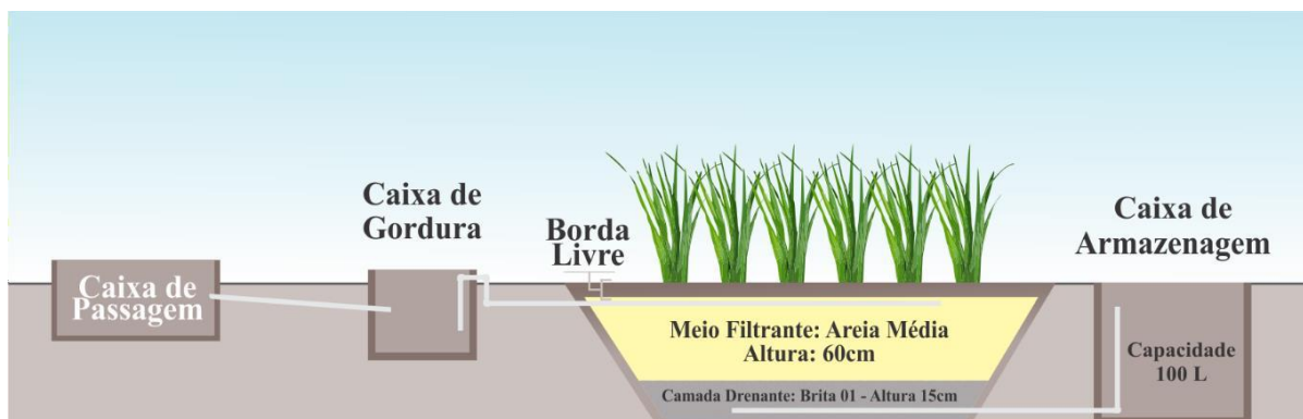
Figura 02 – Esquema técnico do Jardim Filtrante
