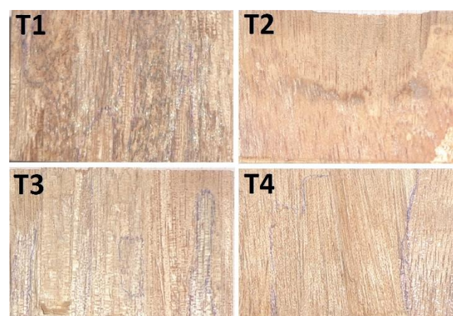
Figura 3. Corpos de prova dos tratamentos após o ensaio de cisalhamento na linha de cola.
