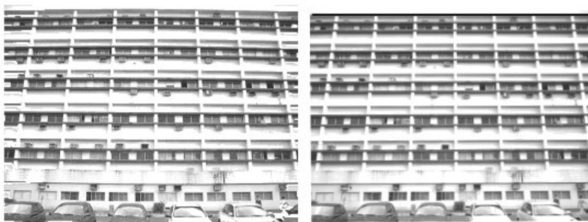
Figura 3. Fotografia (a) com as distorções das lentes e (b) corrigida das distorções
