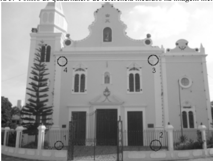
Figura 5. Pontos do quadrilátero de referência medidos na imagem inclinada
