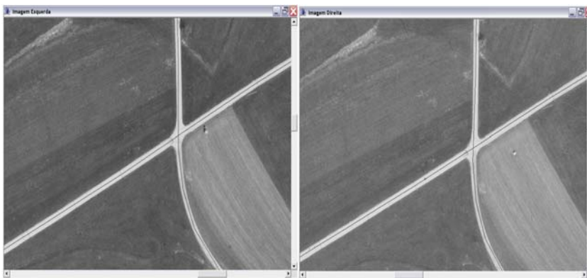
Figura 6 – Correspondências automáticas obtidas por geometria epipolar (imagem esquerda)
