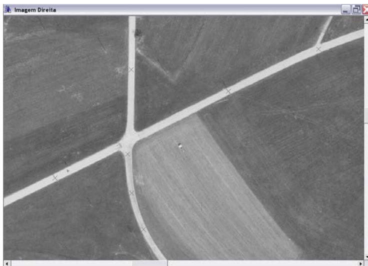
Figura 8 – Eixos extraídos por programação dinâmica (imagem esquerda e direita)
