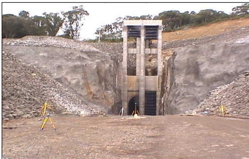
Figura 9: Fotografia tirada pelo próprio equipamento na entrada do túnel, mostrando os diversos tripés com alvos planos, com coordenadas a determinar.
