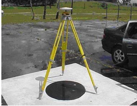
Figura 3 - Ponto pré-sinalizado em forma de círculo
