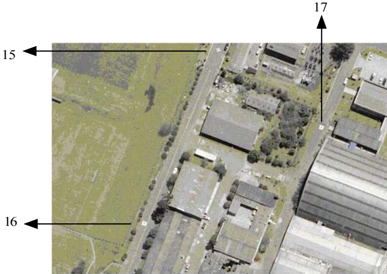
Figura 4 – Pontos pré-sinalizados 15,16 e 17
