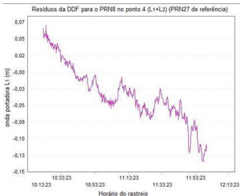
Figura 3: Resíduos das DDF (PRN8), na onda portadora L_1 , com combinação linear L_1+L_2 , para o ponto 4 (em torno de 45 km).
