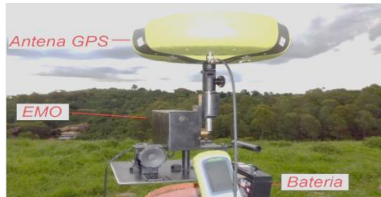
Figura 3: Detalhamento do Oscilador Eletromecânico com a antena JAVAD.
