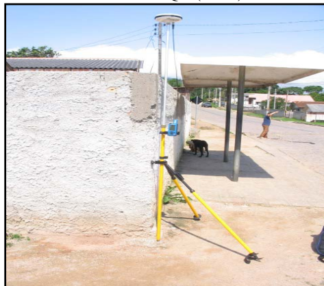
Figura 8 - Levantamento de ponto de apoio por meio de GPS. Fonte: PMQB (2008).
