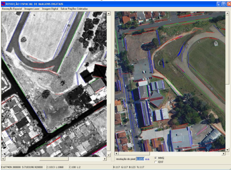
Figura 5: Feições retas extraídas no espeço-objeto (laser) e imagem (imagem digital).
