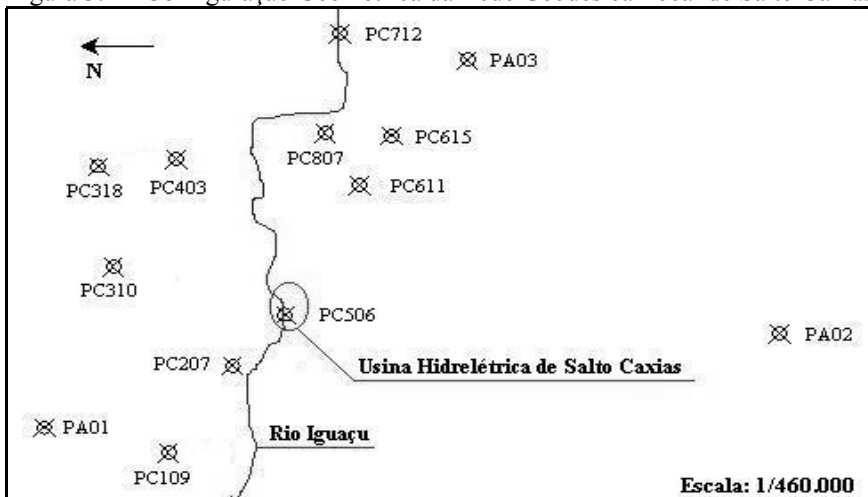
Figura 3.1 – Configuração Geométrica da Rede Geodésica Local de Salto Caxias
