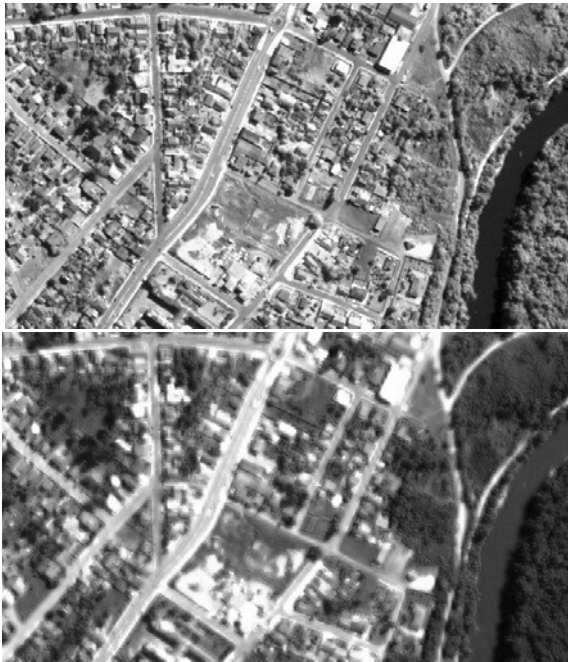
Figura 5. Composição em BGR das bandas 1, 2 e 3 resultantes da fusão pelo método SCP com 4 quatro bandas (a) , e pelo método HPF (b).
