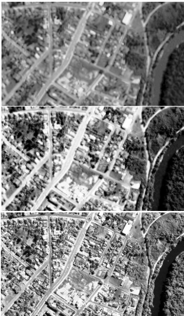
Figura 4. Composição das bandas 1, 2 e 3 em BRG: original (a), resultante da fusão pelo método da substituição (b) e pelo método HSV (c).
