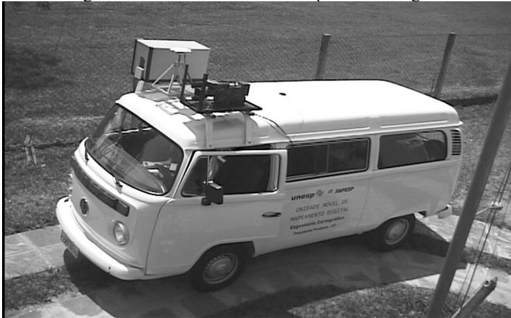
A UMMD é formada por três módulos: o de posicionamento GPS e sincronismo dos quadros, o de aquisição de imagens digitais e o de alimentação de energia. Os principais equipamentos que a compõem são: o automóvel Kombi, um par de vídeo câmaras digitais (Sony DSR 200A), um par de receptores GPS, um microcomputador *notebook* e o dispositivo de sincronismo dos quadros. A fig. 2 mostra o par de câmaras e uma antena GPS sobre o teto do veículo.
