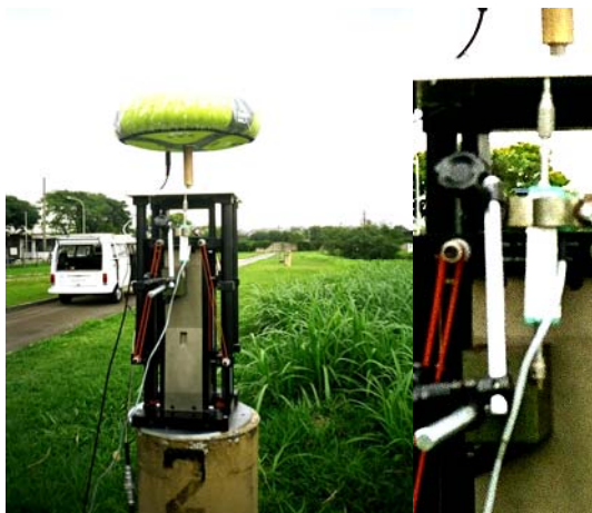
Fig. 1- Antena choke ring acoplada ao shaker sobre o pilar 2 da BASE USP. No detalhe à direita observa-se o transdutor de deslocamento, acoplado.
