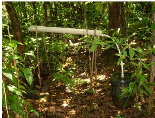
Figura 2. Coletor de precipitação no interior da floresta, em Antonina, PR.
