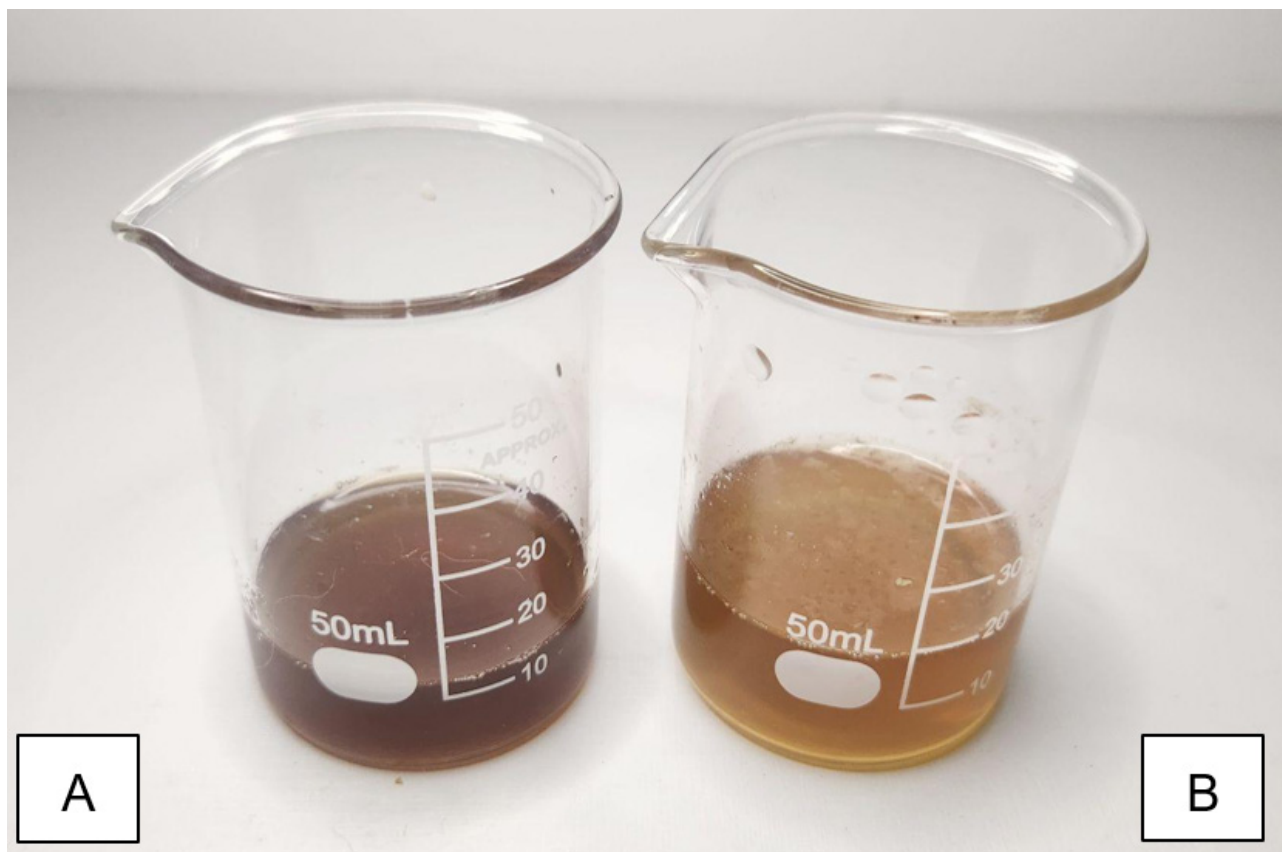
Figura 3. Reação de lugol em duas amostras, A: amostra adulterada com alteração de cor para marrom escuro; B: amostra sem adulteração e alteração de cor.
